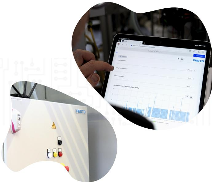
CUMA überwacht und misst automatisch die Konzentration, den pH-Wert und die Leitfähigkeit der Kühlschmierstoffemulsion.
